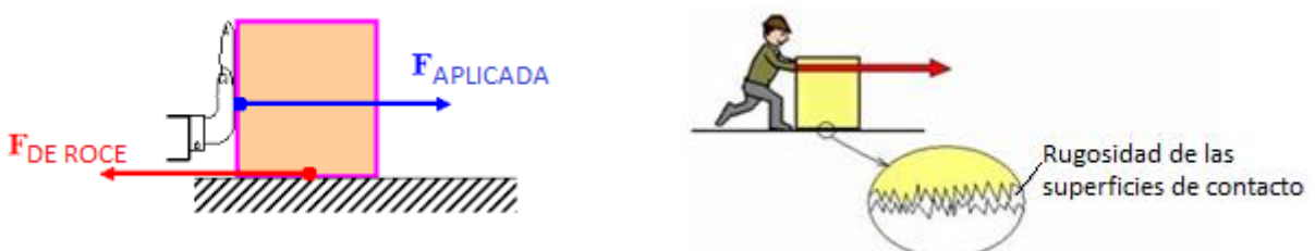
Figura 6: Representación de la fuerza de roce y su origen a escala molecular.
